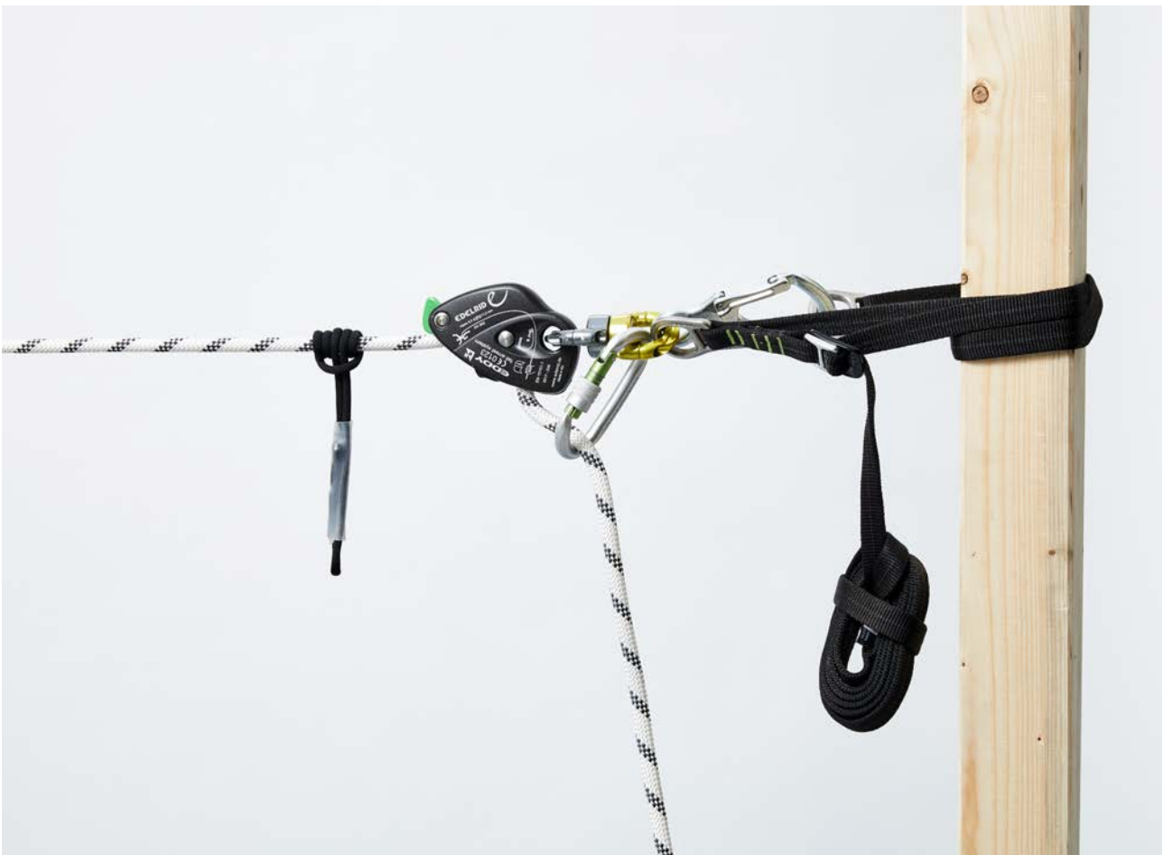
Bild 10: Karabiner in den Wirbel eingehängt und verschlossen
