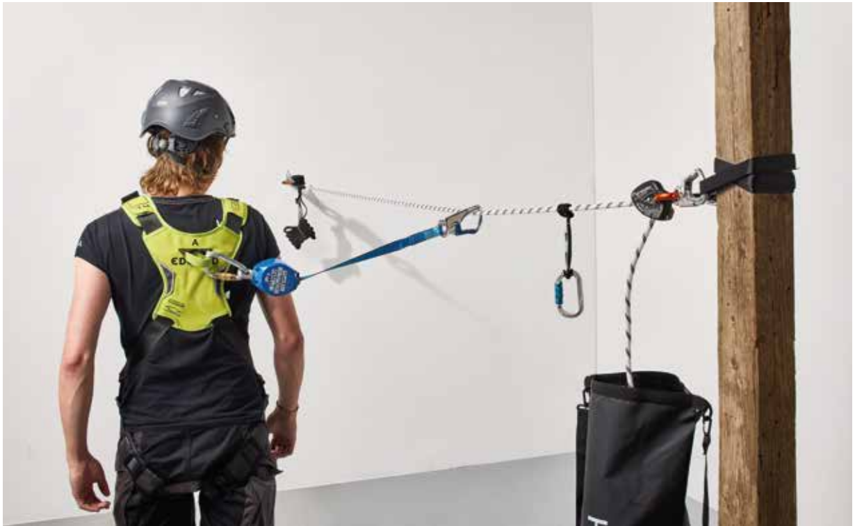
Image 7: Ligne de vie tendue à hauteur du point d'attache dorsale du harnais avec antichute à rappel automatique
