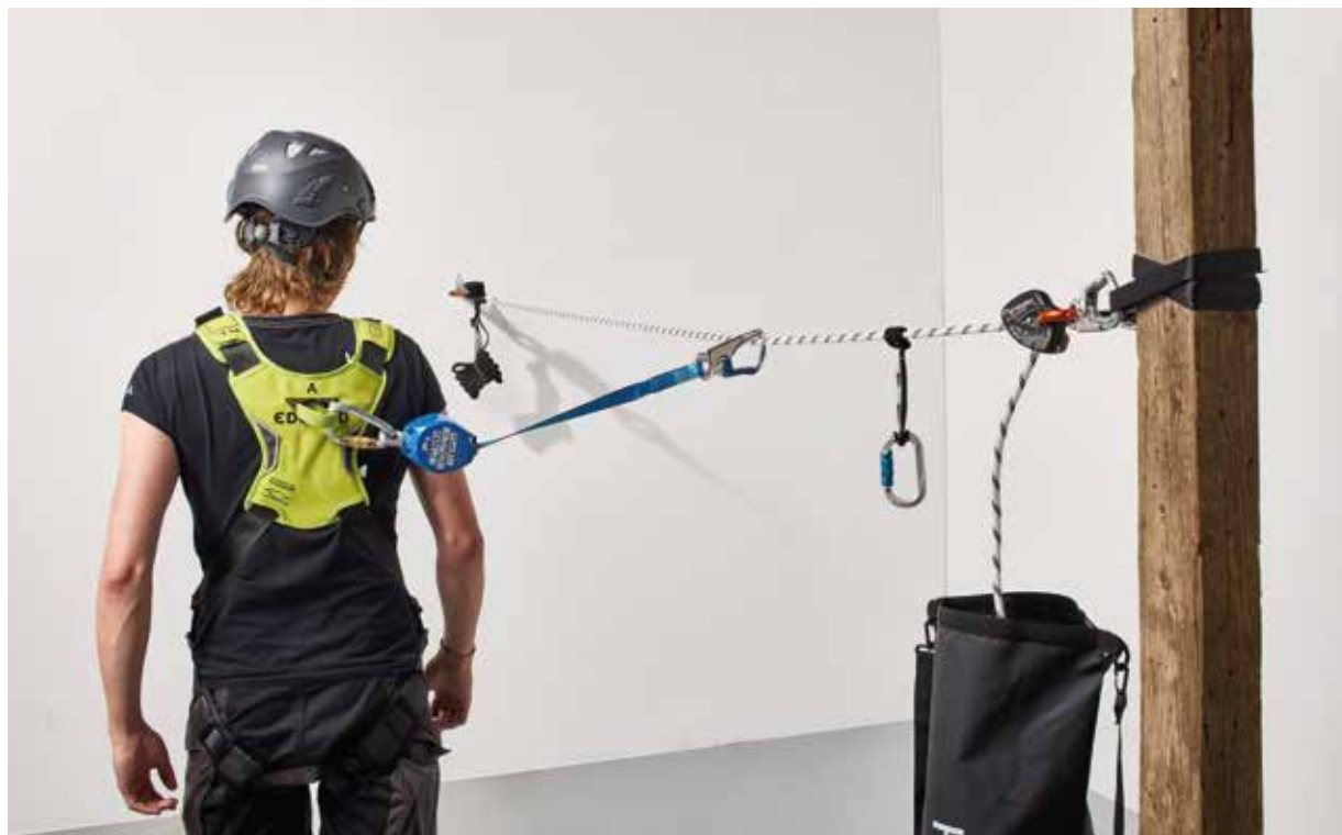
Fig. 7: Linea vita HOLD-system tesa all'altezza del punto di attacco posteriore dell'imbracatura con dispositivo anticaduta retrattile.
