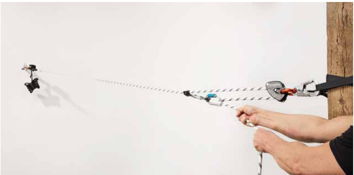
Figura 6: Tensionamento manuale del sistema HOLD-system da parte di una sola persona!
